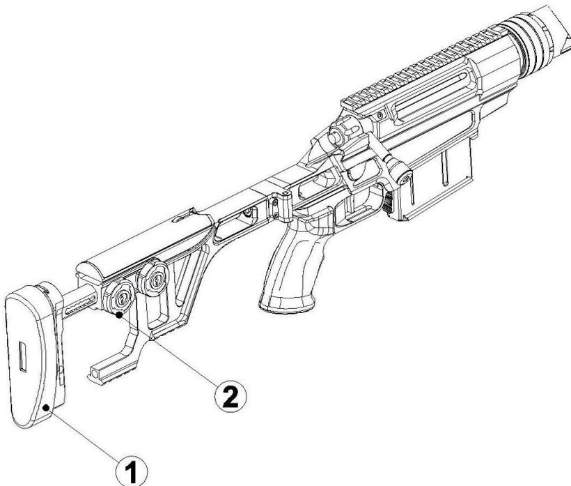
3.6.3. Для регулировки высоты затыльника отверните болт (2) (рис. 6) при помощи шестигранного ключа 3мм. примерно один оборот против часовой стрелки, найдите оптимальную для вас высоту затыльника (1), после чего затяните болт (2).
