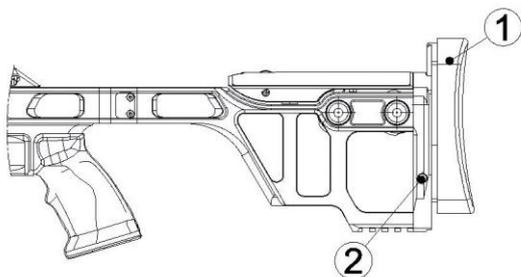
3.7. Для удобства транспортировки карабина его приклад выполнен складным. Чтобы сложить приклад убедитесь, что регулируемая щека приклада находится в нижнем положении, затем поднимите рукоятку затвора вверх, после чего нажмите защелку (1) (рис. 7) и сложите приклад до упора вправо. Затем опустите рукоятку затвора вниз до касания со щекой и застегните крюк (1) (рис. 8) фиксации приклада, расположенный в пазу «щеки», в канавку рукоятки затвора.
