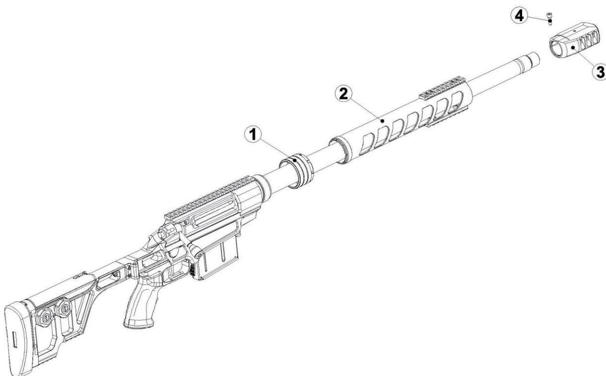
8.1.2. Отверните гайку крепления цевья (1), (на рис. 9), используя специальный ключ (в комплекте поставки с доп. стволом.) и снимите цевье 2
